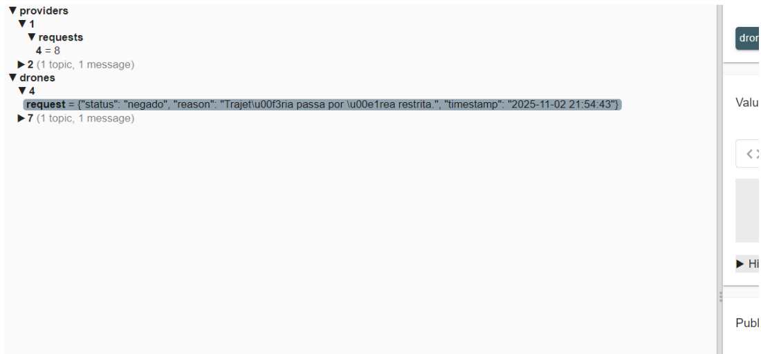
FIGURA 4.6 – Mensagem MQTT publicada pelo Provider 1 para o drone 4.
