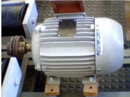
Figura 3. Motor trifásico de indução.
