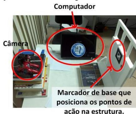
Figura 5 - Camera e marcador de base com os pontos de ação que controlam o aplicativo guia.
