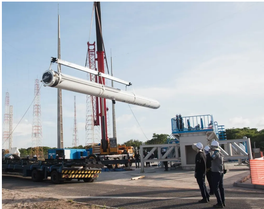
FIGURA 3.2 – Foguete HANBIT-TL da Innospace sendo colocado na área de lançamento. Fonte: (FAB, 2022).
