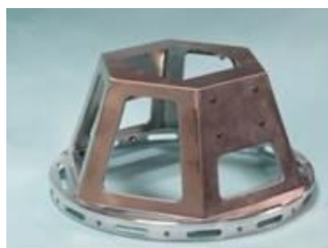
FIGURA 2.7 – Estrutura de montagem do satélite no SS-520-5. Fonte:(INATANI; OHTSUKA, 2018)
